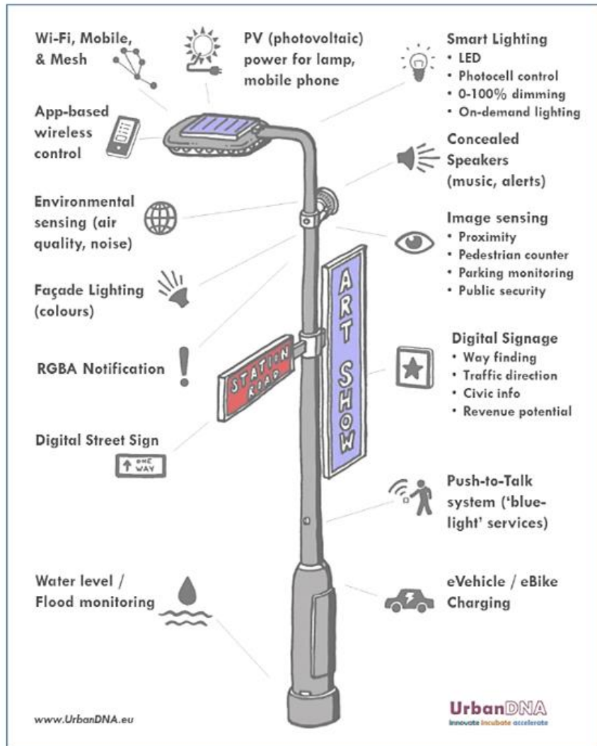
Figura 18. Lampione intelligente del progetto Humble Lamppost
