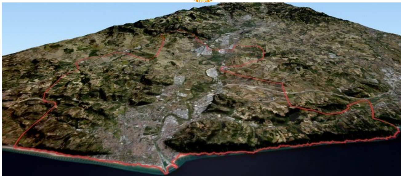
Ricostruzione modello 3d territorio Pesaro (basato su EU - DEM GMES RDA project e immagine BING Aerial)
